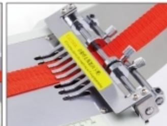
进料自动感应口，一旦材料用完，将自动停止工作。
