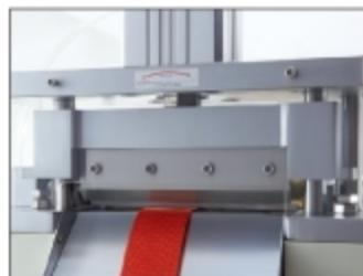
刀刃采用优质进口钢材制成，使用寿命长。
