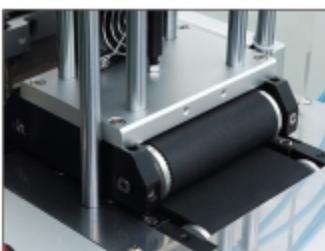
同步带输送装置，送带更平稳，切弹性材料更精确。
