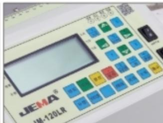
LCD操作面板，中英文显示，易学易操作，便利快捷键设定方便、具有补偿功能；更精确，独创精确功能，能精确到小数点后4位；其他方便的使用功能都在操作面板
