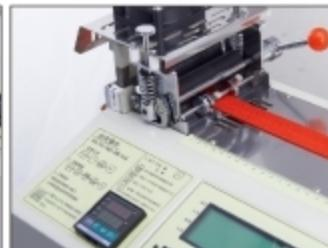
温控器，在开机状态下，可以按“▼”键降低设置温度，最低可以设置为0℃按“▲”键升高设置温度，最高可以设置为350℃
