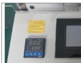
温控器，在开机状态下，可以按“▼”键降低设置温度，最低可以设置为 0℃ 按“▲”键升高设置温度，最高可以设置为 350℃
