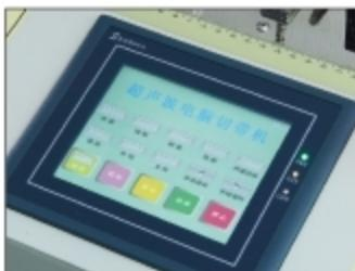
LCD操作面板，中英文显示，易学易操作，便利快捷键设定方便、具有补偿功能；更精确，独创精确功能，能精确到小数点后4位；其他方便的使用功能都在操作面板
